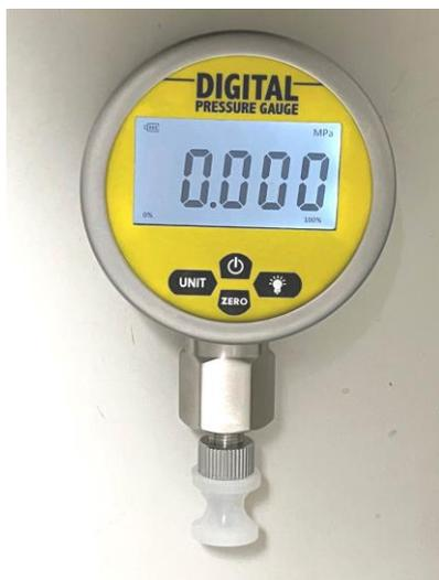
BQSLバキュームプレッシャーテスターはホットパック飲料/食品の真空度又は内圧測定専用開発された半導体歪みゲージセンサーを搭載した電池式デジタル表示の圧力計です。
